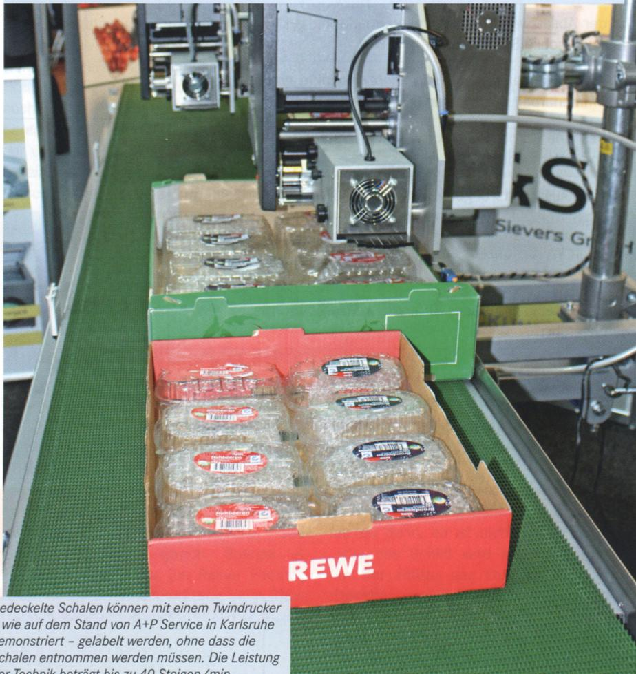
Gedeckelte Schalen können mit einem Twindrucker – wie auf dem Stand von A+P Service in Karlsruhe demonstriert – gelabelt werden, ohne dass die Schalen entnommen werden müssen. Die Leistung der Technik beträgt bis zu 40 Steigen/min
